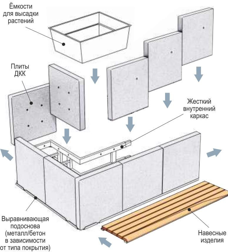
Система «Тетрис» — это совмещение жёсткого металлического каркаса, выравнивающего элемента (подосновы) из металла или бетона, навесных изделий (скамеек, урн, велопарковок и пр.), емкостей для высадки растений (в случае клумб шириной менее 1,5 м ), закладных и анкеров (опционально).
